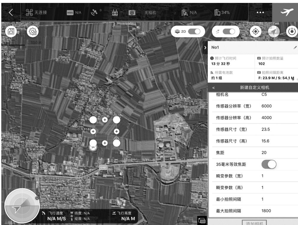
按上图设置相机参数，设置完成后点击添加相机
